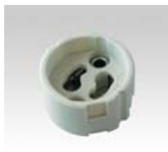
Наименование Фасунга GU10 Арт.номер GU10 Параметри GU10; 1x50W max; 220V; Доп.информация Вкл. и кабел 15см
